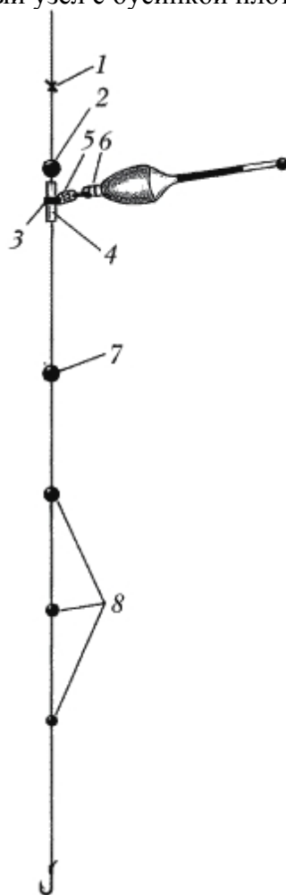
Рис. 181. Оснастка для дальнего заброса: 1 – стопорный узел; 2 – стопорная бусинка; 3 – резиновый кембрик для закрепления карабинчика поплавка; 4 – силиконовая трубочка; 5 – карабинчик; 6 – регулируемая огрузка поплавка; 7 – фиксирующая дробинка; 8 – дополнительные дробинки
