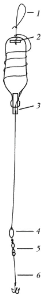
Рис. 272. Жерлица из пластиковой бутылки: 1 – петля для подвешивания жерлицы; 2 – стопорная палочка; 3 – палочка с расщепом для лески; 4 – скользящая «оливка»; 5 – вертлюжок; 6 – металлический поводок с тройником
