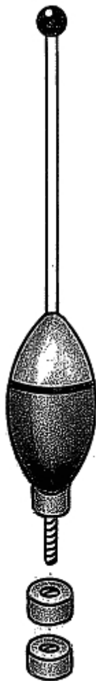
Рис. 98. Оснастка поплавка съёмными утяжелёнными кольцами
