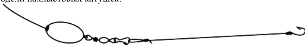
Рис. 295. Простая оснастка полудонки с грузилом-«оливкой», вертлюжком и карабином
