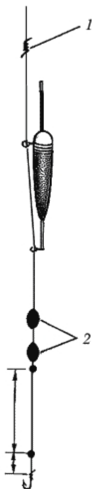
Рис. 139. Огрузка оснастки со скользящим поплавком для ловли на сильном течении: 1 – стопорный узел; 2 – скользящие грузила
