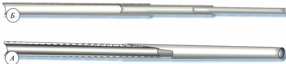
▲ Рис. 10. Типы соединений удилищ: А — «телескоп», Б — штекерное.
