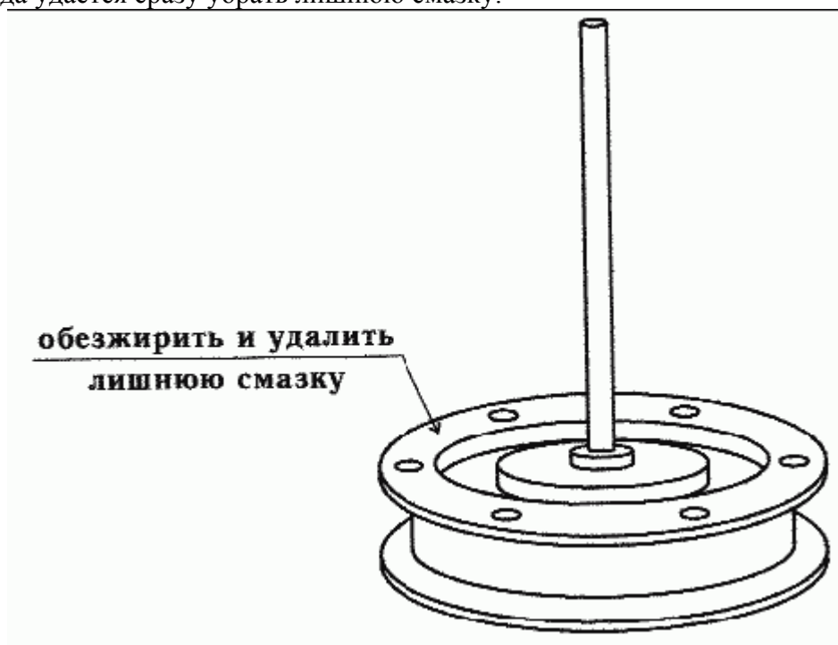
Рис. 17. Удаление лишней смазки с поверхности зеркала катушки
